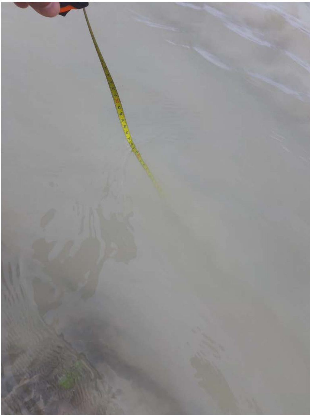
Малюнок 14 Шар прозорі води близько 10 см на виході ємності №21 в канал. 28.09.2021
